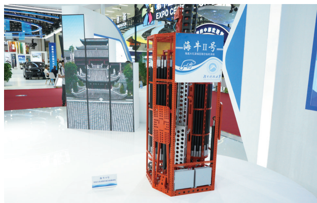
中部博覽會湖南館展示的海牛II號海底大孔深保壓取芯鑽機系統
